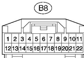
**Гнездо ключа зажигания в сборе
